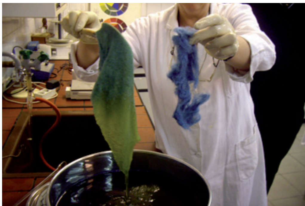
Fig. 14. Teinture expérimentale en cuve au laboratoire de l'Université des Arts appliqués à Vienne, Département d'Archéométrie : le colorant de cuve était fabriqué à partir d'indigo naturel et l'agent réducteur dithionite de sodium. La toison et des textiles en laine ont été trempés dans ce liquide de couleur vert-jaune. Le contact du textile teinté avec l'air transforme sa couleur du vert-jaune au bleu.
